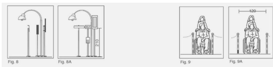
Fig. 9- Ostacolo costituito da varchi di larghezza insufficiente tra paline con catenella.
